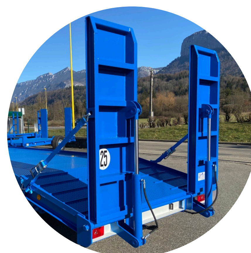
Rampes arrière en tôle larmée avec distributeur réglable en largeur avec barrettes
