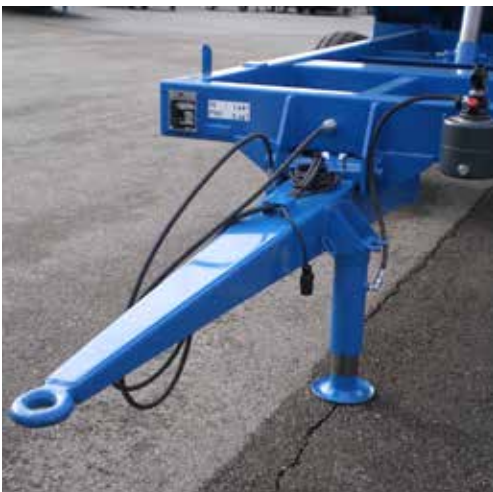
Flèche ressort avec béquille hydraulique et pompe manuelle
