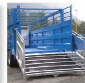
Pont hydraulique & volets en tôle pliée
